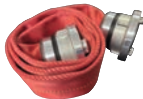
Artikelnummer: 151475 H B-75 Schlauch Druck-/Rollschlauch mit speziellem Drahteinband, beidseitig Storz-B mit Ver- riegelung. Typ: Gollmer + Hummel Progress Spezial, Länge: 5 m
